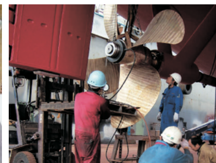
プロペラ軸径φ240のプロペラの油圧押込み
