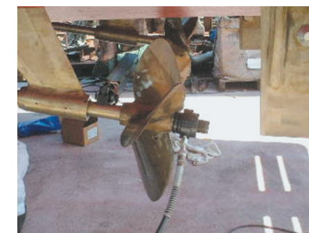
プロペラ軸径φ55のプロペラの油圧押込み
