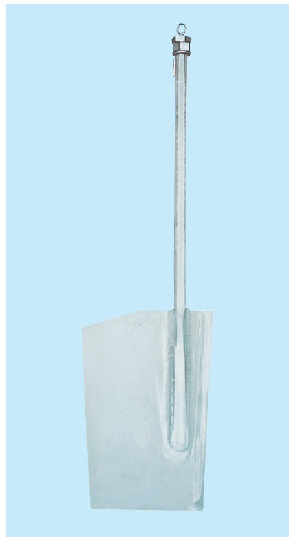
舵軸、舵板は熔接構造
