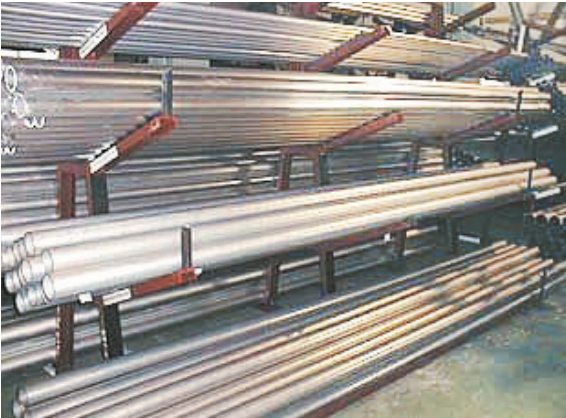
アルミ合金製パイプ管理状況
