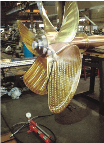
油圧押し込みによる プロペラ組み立て
