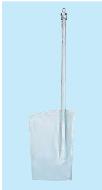
舵軸、舵板は熔接構造
