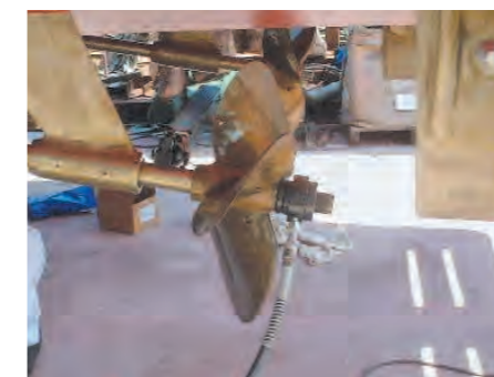
プロペラ軸径φ55のプロペラの油圧押し込み
