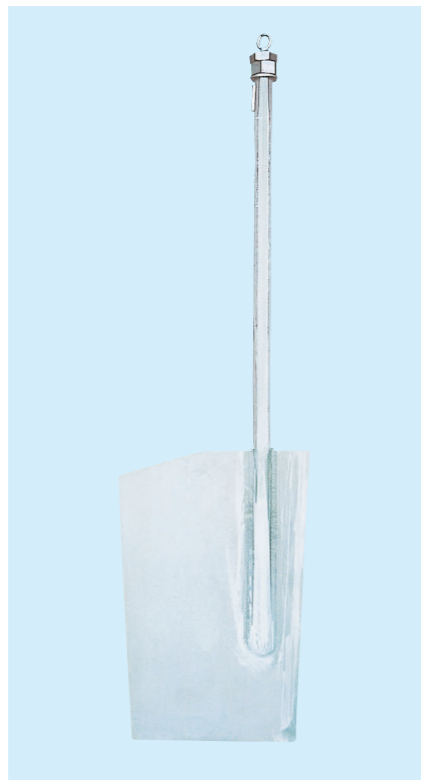
舵軸、舵板は熔接構造
